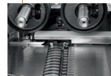
Rebating cutter The first planer spindle is equipped with rebating cutter. The special lips of the table next to the planer head greatly reduce the noise produced by the cutterhead Arbre dégaugé avec fraise référenceuse L'arbre dégaugé est équipé d'une fraise référenceuse. L'usinage particulier à peigne des plaques sur la table de travail réduit le bruit de l'outil
